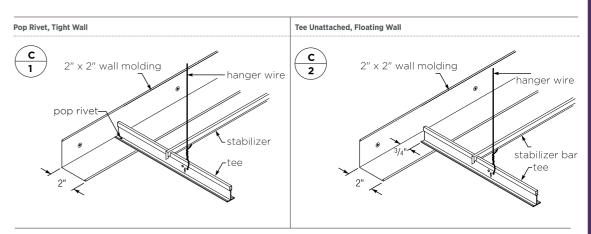
5MM SEISMIC SHADOW MOLDING
